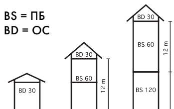
Рис 4. Требования по огнестойкости конструкции
